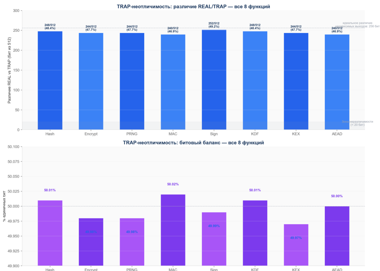
Рис. 7 TRAP-режим: REAL и TRAP криптографически различны для всех 8 функций (различие 240–252 бит из 512, среднее ~47,5%), при этом статистический баланс TRAP-выхода остаётся в пределах 49,97–50,02% для всех функций, что подтверждает полную неотличимость TRAP от случайного распределения.
