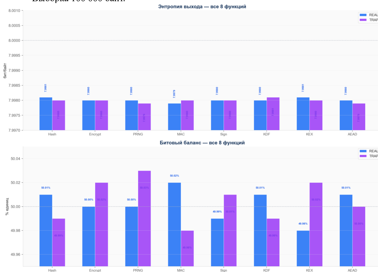
Рис. 6 Энтропия и битовый баланс для режимов REAL и TRAP.
